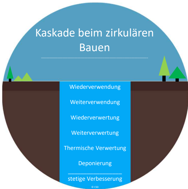
Kaskadenmodell des zirkulären Bauens [CSD INGENIEURE]
