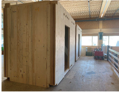
Abbildung 8: Badmodule in der Werkhalle
